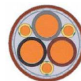
Рис. 2.2 Переріз кабелю HELUKABEL TOPFLEX-EMV-3 PLUS-2YSLCY-J 600/1000 B
